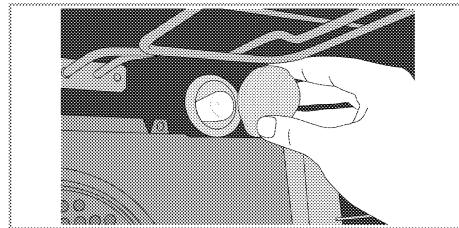
3. אם נורתה התנור היא מסוג (A) כפי שמצוג באירור שלහלן, הסר אותה על ידי סיבובה כפי שמצוג והחלף אותה. אם הדיא מסוג (B) משוך והסר אותה כפי שמצוג, והחלף אותה.
